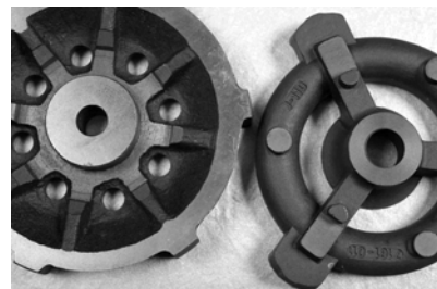
Plato descarga con sección de paso aumentada: MENOR PÉRDIDA DE CARGA MAYOR RENDIMIENTO
